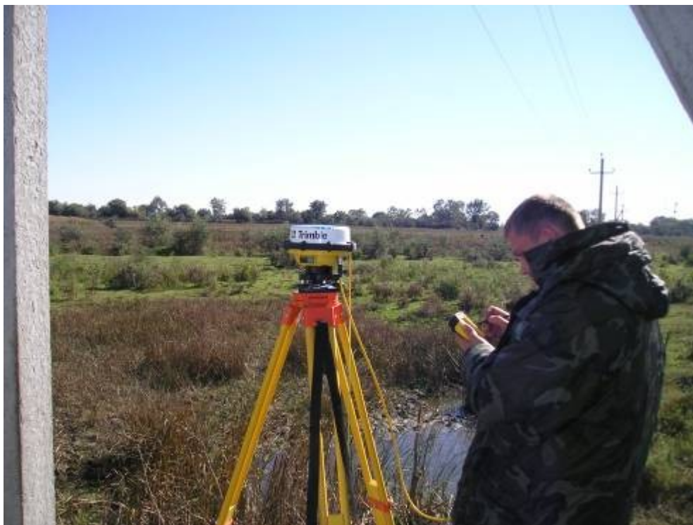
Рис.13. Геодезист Калашников А. А. выполняет спутниковые измерения с использованием GPS-оборудования на участке нефтепровода «Обвод ЧР», канал Кизлярский, Республика Дагестан
